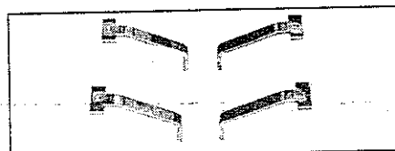
U-20000 Brida fijación motor a caballete
