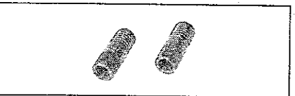
U-40023 Pernos de centrado para montaje de la culata.
