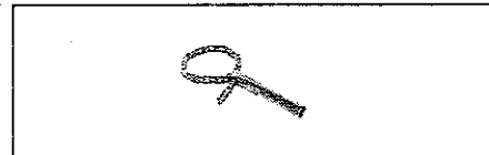
U-10068 Util desmontaje filtro de aceite.
