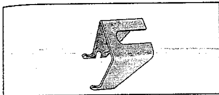
U-30015 Útil sujeción cable de embrague.
